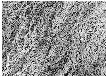
Figura 2: Superficie compatta con funzione di barriera cellulare (SEM 1500x)
